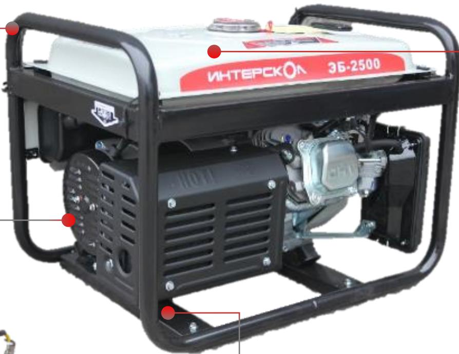
Двигатель закреплен на раме через вибrogасящие подушки
